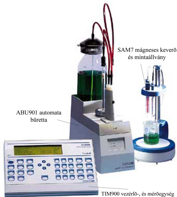
6. ábra. A TitraLab90 automata titráló három fő egysége
